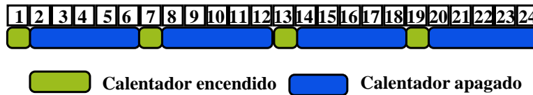
Figura 2: Ciclo de trabajo del calentador
